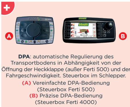
**DPA:** automatische Regulierung des Transportbodens in Abhängigkeit von der Öffnung der Heckklappe (außer Ferti 500) und der Fahrgeschwindigkeit. Steuerbox im Schlepper.
